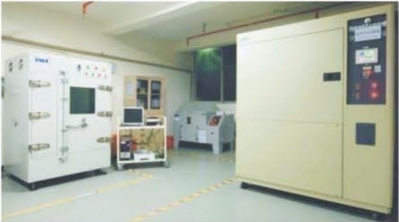
Испытательный бокс с естественной конвекцией (слева) Испытательный бокс с холодным и горячим ударом (справа)
