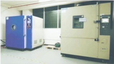
Стенд низкого давления (слева) Стенд с постоянной температурой и влажностью (справа)
